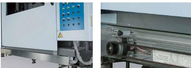
操作側の安全ドアの自動開閉装置に電動式を採用し、かつ標準装備としました。スムーズかつ迅速な動作で、作業性向上に貢献します。従来機より60%速度アップ。さらに成形機本体はエアが不要となります。
