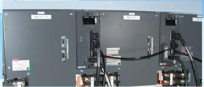
最新オールデジタルサーボシステム搭載により、従来より高応答制御が可能です。サーボアンプ間の通信に光ケーブルを採用し、外乱、ノイズにさらに強くなりました。さらにコンパクトかつ冷却効率も向上し、信頼性を向上しています。
