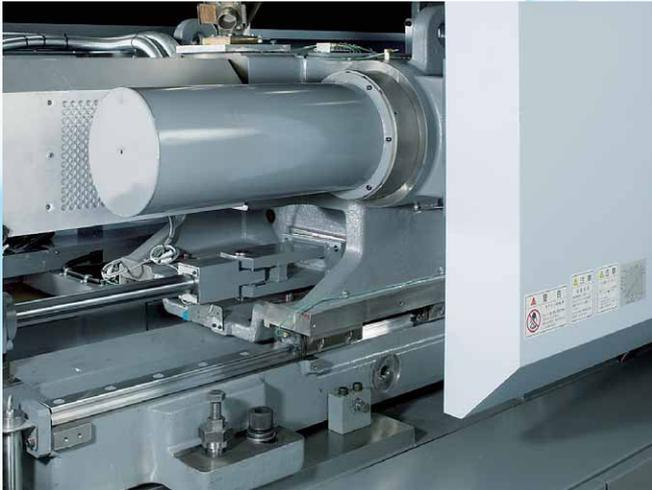
射出ユニット摺動部にリニアガイドを採用し、摺動抵抗を低減し、射出速度の応答性を向上しました。サーボアンプの応答性能向上とともに、よりきめ細かい射出制御が可能となります。
